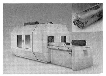
Der Vario-Packomat ist problemlos in jede automatische Produktionsstrasse zu integrieren. Seine gefällige Rundumverkleidung garantiert hohe Arbeitssicherheit und senkt die Geräuschbelastung auf unter 70dBa. Eine eng verschweisste Folie mit optimalem Stirnverschlussichert das Produkt im Erforderlichen Mass und garantiert so eine «bessere Verpackung».
