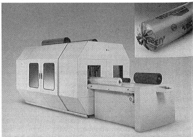
Der Vario-Packomat ist problemlos in jede automatische Produktionsstrasse zu integrieren. Seine gefällige Rundumverkleidung garantiert hohe Arbeitssicherheit und senkt die Geräuschenbelastung auf unter 70dBa. Eine eng verschweisste Folie mit optimalem Stirnverschluss sichert das Produkt im Erforderlichen Mass und garantiert so eine «bessere Verpackung».
