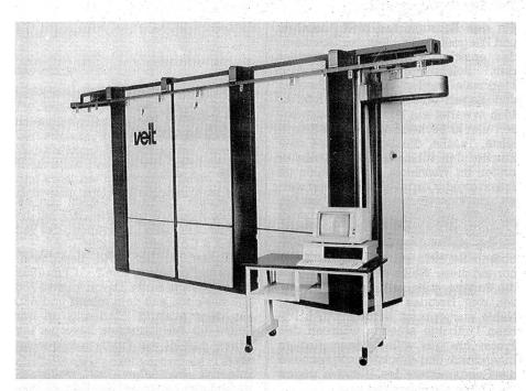
Tunnel-Finisher Veit Variant Durch das Baukastensystem ist eine schnelle Kapazitätserweiterung jederzeit möglich.
