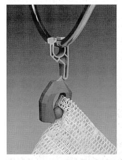
Veit-Gleiter Charakteristisches Merkmal des Veit-Gleiters ist die Möglichkeit, die Ware sowohl innerhalb als auch ausserhalb der Schiene zu bearbeiten.
