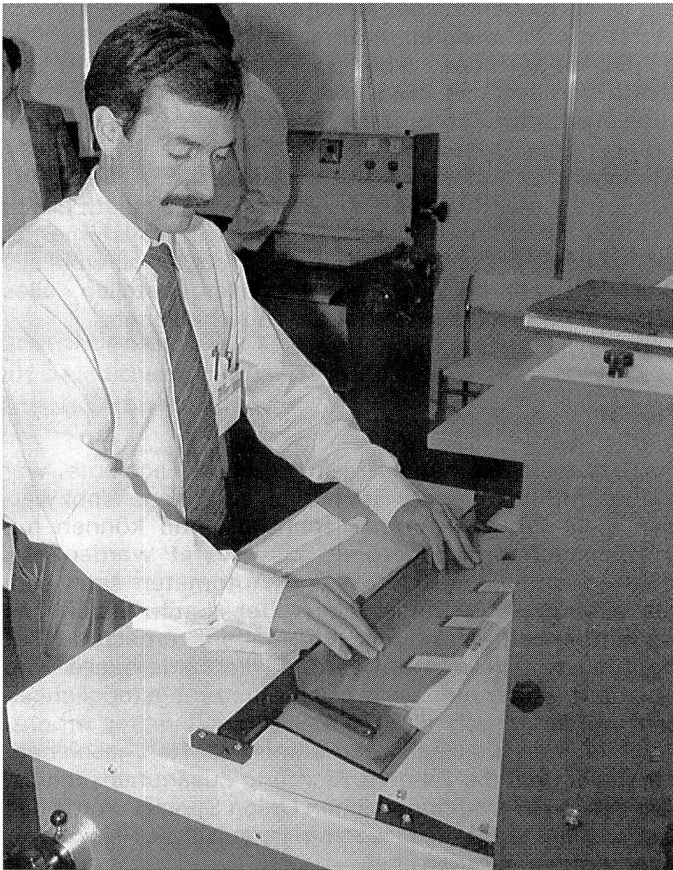
Falt- und Umbuggerät der Gygli Technik AG, Zug. Erfinder Urs Bächtiger beim Einlegen der Stanzlinge in die Presse: «Bei einer Produktion von ca. 1500 ist die Einsparung 10–12 Rappen pro Stück.»
