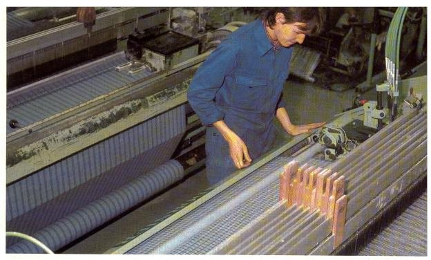
Kontrolle der Bindungsstruktur an der Webmaschine
