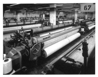
Sulzer Rüti Webmaschinenanlage der Steiger & Deschler GmbH in Ulm in der Bundesrepublik Deutschland. Auf 66 Projektilwebmaschinen in Arbeitsbreiten von 334 und 393 cm stellt das Unternehmen u.a. qualitativ hochwertige technische Gewebe her. Die Gruppe Steiger & Deschler-Interglas verfügt in ihren verschiedenen Anlagen über 800 Sulzer Rüti Projektil-, Luftdüsen- und Greiferwebmaschinen.
