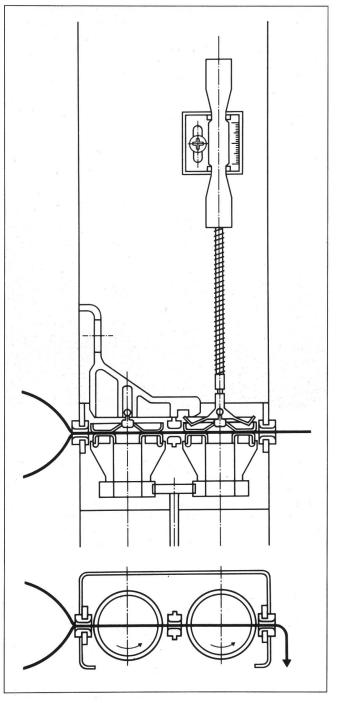
Abb. 7: Normaldruckspanner GZB-F, Schnitt und Aufsicht
