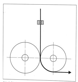
Abb. 4: Prinzip dynamischer Spanner
