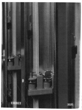
Abb. 5: Ansicht eines Einzelspanners GZB, Standardausführung
