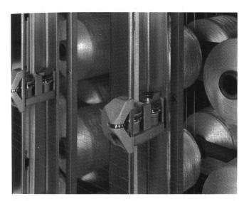
Abb. 6: Normaldruckspanner GZB mit Umlenkrolle
