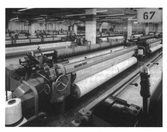
Sulzer Rüti Webmaschinenanlage der Steiger & Deschler GmbH in Ulm in der Bundesrepublik Deutschland. Auf 66 Projektilwebmaschinen mit Arbeitsbreiten von 334 und 393 cm stellt das Unternehmen u. a. qualitativ hochwertige technische Gewebe her. Die Gruppe Steiger & Deschler verfügt in ihren verschiedenen Anlagen über mehr als 600 Sulzer Rüti Projektil-, Luftdüsen- und Greiferwebmaschinen.
