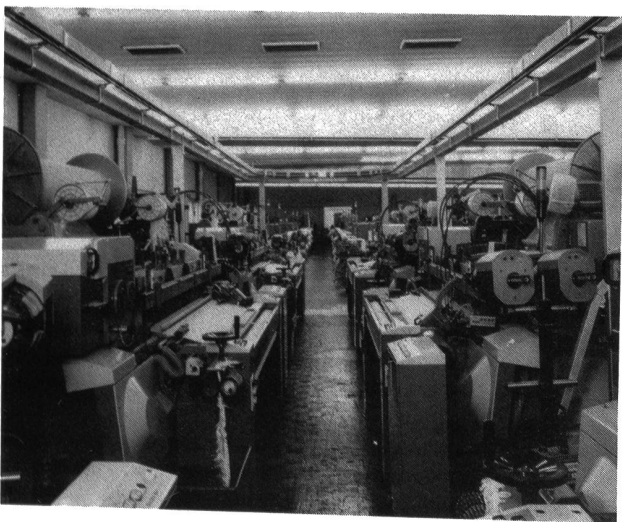
Webmaschinenanlage der Feinweberei Elmer AG in Wald in der Schweiz: Neben 136 konventionellen Rütli C-Maschinen setzt das Unternehmen 24 Sulzer Rütli Luftdüsenwebmaschinen L 5001 und L 5100 sowie 25 Sulzer Rütli Vierfarben-Greiferwebmaschinen des Typs F 2001 in Arbeitsbreiten von 190 bis 230 cm ein.
