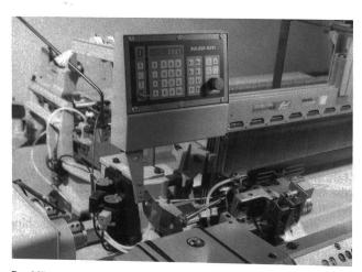
Der Mikroprozessor an der Sulzer Rüti Luftdüsenwebmaschine L 5100 erfasst, überwacht, steuert, regelt, und optimiert rund 140 verschiedene maschinen- und textilspezifische Parameter, die über die Tastatur des Bedienungsterminals eingegeben und jederzeit abgerufen werden können.
