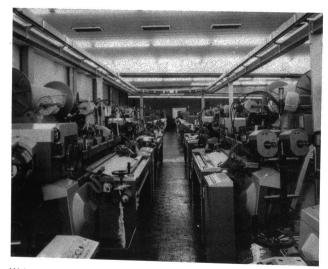
Webmaschinenanlage der Feinweberei Elmer AG in Wald in der Schweiz: Neben 136 konventionellen Rüti C-Maschinen setzt das Unternehmen 24 Sulzer Rüti Luftdüsenwebmaschinen L 5001 und L 5100 sowie 25 Sulzer Rüti Vierfarben-Greiferwebmaschinen des Typs F 2001 in Arbeitsbreiten von 190 bis 230 cm ein.
