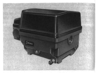
Hochleistungs-Rotations-Schaftmaschine, Typ 2660, mit elekt nischer Steuerung. Diese elektronisch gesteuerte rücklauffähig Schaftmaschine arbeitet aus jeder Stellung heraus schussfolgerich und immer mit der Webmaschine synchron.
