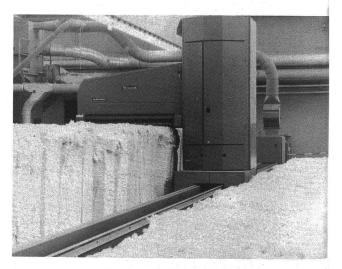
In der Spinnerei-Vorbereitung ist ein automatischer Ballenöffner Bleidomat der Firma Trützschler eingesetzt.
