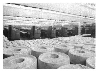
Die Schlafhorst-Autocoro-Rotor-Spinn-Maschine, das Herzstück der automatischen Spinnerei bei der Firma Rositta.
