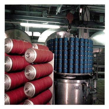
metrik können täglich bis gegen 100 Muster zwischen 10 Gramm und 5 Kilogramm eingefärbt werden. Der Einsatz erfolgt natürlich auch für die Kammzugfärberei. Die Kapazität der Garnfärberei liegt bei 1400 Tonnen p.a. bei 2½ schichtiger Auslastung.
