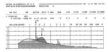
Fig. 2: Spektrogramm des Streckenbandes (1. Passage: Ablieferung 1) 1) Defekter Lieferzylinder an der Strecke
