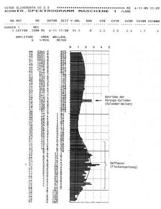
Fig. 4: Kontroll-Spektrogramm der Karde
