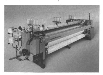
Abb. 4: Die neue Sulzer Rüti Luftdüsen-Webmaschinengeneration L 5100 – hier eine Maschine mit Mischwechsler mit einer Arbeitsbreite von 380 cm, ausgerüstet mit Schaftmaschine und 2 Adhäsionsspeichern, zweibahnig belegt mit einem Baumwollköper.
