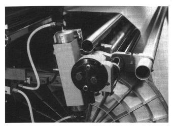
Abb. 9: Der Webkettenspanner garantiert optimale Spannungsverhältnisse und ist besonders bedienungsfreundlich.
