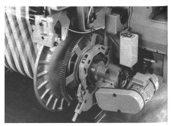
Abb. 8: Der elektronisch gesteuerte Kettablass gewährleistet eine konstante Spannung vom vollen bis zum leeren Kettbaum.
