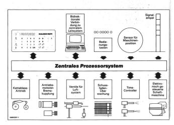
Abb. 14: Aufbau und Funktionen des zentralen Prozessorsystems.
