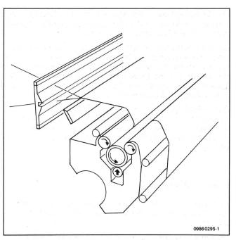
Abb. 11: Der schwimmende Schaltbaum gewährleistet erhöhte Stabilität
