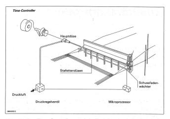
Abb. 15: Der Time-Controller regelt in Funktion der Ankunftszeit des Schussfadens den Hauptdüsendruck und gleicht Streuungen der Schusseintragszeit von der vollen bis zur leeren Vorlagespule aus. Abweichungen von der Soll-Ankunftszeit werden gemessen und der Hauptdüsendruck jeweils auf den optimalen Wert eingestellt.
