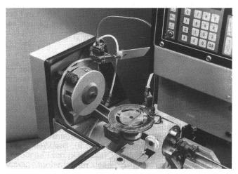
Abb. 3: Der Adhäsionsspeicher bietet besondere Vorteile und beste Voraussetzungen für den Schusseintrag bei Verarbeitung schwererer Spinnfasergarne auf breiten Maschinen.
