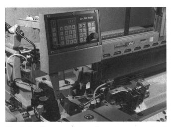
Abb. 13: Der Mikroprozessor erfasst, überwacht, steuert, regelt und optimiert rund 140 verschiedene maschinen- und textilspezifische Parameter, die über die Tastatur des Bedienungsterminals eingegeben und jederzeit abgerufen werden können.
