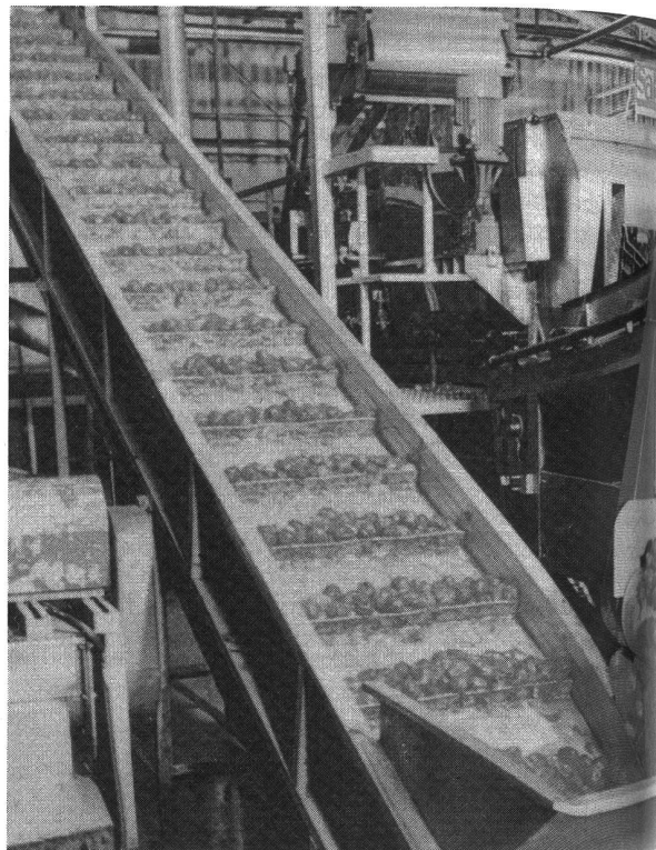
Volta-Steilförderband mit Stollen.
