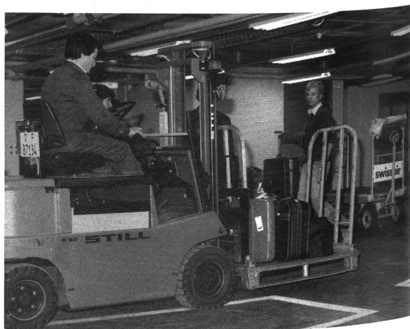
STILL Elektro-Stapler in SBB-Ausführung beim Gepäckumschlag im Sortierraum des Flughafen-Bahnhofs Genf.
