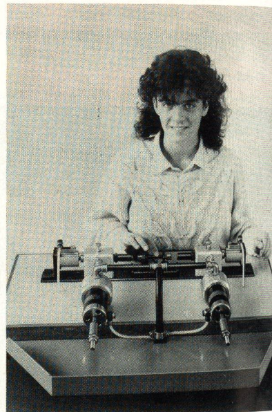
Die pneumatische Achsensmieranlage für die Zylinderei, übertrifft die bisherigen manuellen Geräte in Bezug auf Schnelligkeit, Sauberkeit, Universalität und Einfachheit bei weitem.
