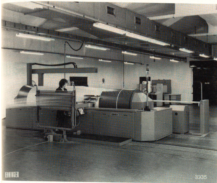
Elektronische Konusschärmaschine Supertronic mit automatischer Bandzugregulierung für höchste Kettqualität.
