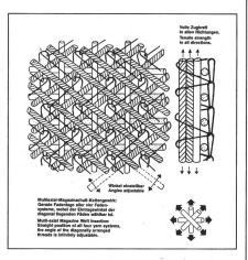
Multiaxial-Magazinschuss-Kettengewirk: Gerade Fadenlage aller vier Faden-Systeme, wobei der Eintragswinkel der diagonal liegenden Fäden wählbar ist.
