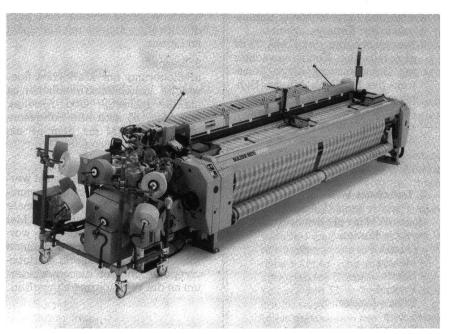
Sulzer Rüti Vierfarben-Projektilwebmaschine mit einer Nennbreite von 390 cm, belegt mit einem Dekostoff, ausgerüstet mit Schaftmaschine, elektronisch gesteuertem Kettablass und automatischer Schussuch- und Fachhebevorrichtung.
