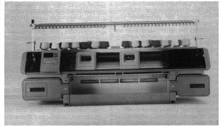
Elektronisch gesteuerter Flachstrickautomat in Tandemausführung (2×2 Systeme) der neuen CMS-Baureihe der Firma Stoll.
