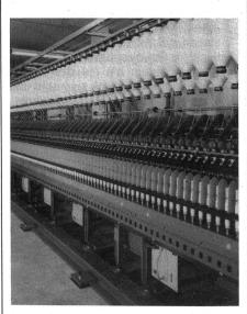
Ringspinnmaschine mit digitaldrehzahlgeregeltem Einzelspindelantrieb von BBC
