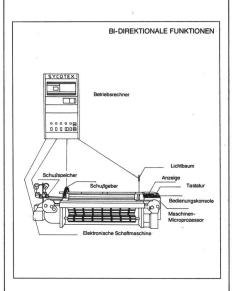
Z.B. kann bei diesem Einsatz der elektron. Schaftmaschine die zur Zeit laufende Bindung abgefragt werden und nach Bedarf online mit der CAD-Anlage abgeändert werden
