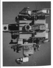
Spleisser an der Murata Düsenspinnmaschine
