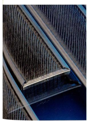
s ist eine eigentliche Neuentwicklung, es ist die erste ckelgarnitur mit progressiver Besetzung. Dabei ist der ladelte Teil der einzelnen Decken auf der Einlaufseite ativ weit gesetzt und wird kontinuierlich feiner gegen Auslaufseite, wo jeweils der engste Einstellpunkt
