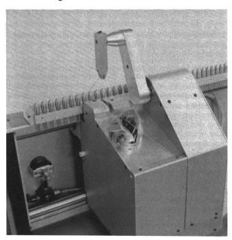
Bild 3 Autonom arbeitender Spulenwechslers mit Knoter
