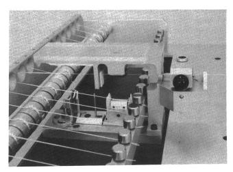
Bild 2 Autonom arbeitender Spulenwechsler mit Spleisser
