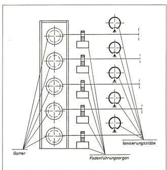
Schematischer Aufbau Ionisations-System an Zettelgatter.
