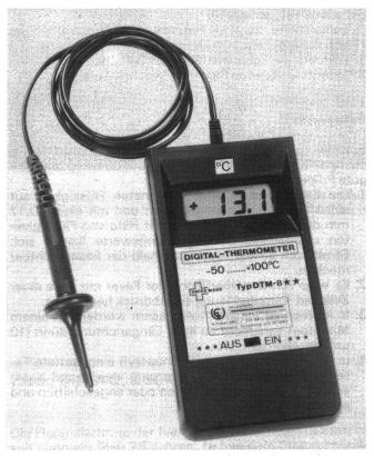
Gemessen wird im Bereich von -50°C bis 150°C mit einer Genauigkeit von besser als 1%. Die Anzeige erfolgt mit grossen Ziffern in 0,1%-Schritten. Versorgt wird das DTM-8 mit einer normalen 9 Volt-Batterie.
