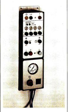
Ein grosses Interesse fand auch die Weko-Rotorenfeuchtung neue «Compact». RF-Compact, eine logische und sinnvolle Weiterentwicklung der Weko-Rotorenfeuchtung mit der neuen zentralen Flottenversorgung. Sie ist die Antwort auf die Forderung aus der Praxis, den Aufwand für den Einbau, die Verschlauchung und elektrische Verkabelung zu vereinfachen und Fehler auszuschliessen. Das neue Weko-Konzept ist gleichzeitig wesentlich bedienungs- und wartungsfreundlicher.
