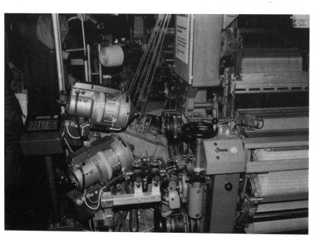
Vom Einfarbenschusseintrag zum mehrfarbigen Schusseintragungssystem. Das mikroprozessorgesteuerte System AIRO für Lüftdüsen-Webmaschinen machts möglich. Produzent: IRO AB, Ulriceham/Schweden Bild: mittex
