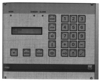
™ Bedienungseinheit mit Eingabetasten und LCD-Anzeige für ≋Dialog mit dem System.
