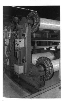
ine neue Assemblieranlage für Filamentane mit einzeln gesteuerter Fadenschar di Zettelbäumen. Eine Entwicklung der laschinenfabrik Zell in Zusammenarbeit der Viscosuisse SA, Emmenbrücke/Chweiz
