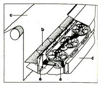
Die Figuren 1 und 2 zeigen das Funktionsprinzip der Weko-Rotorenfeuchtung:
