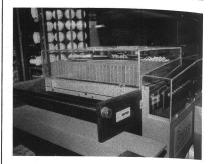
Elektronisches Steuergerät für Jacquard-Webmaschinen. Steckplatten übernehmen die Steuerung der Kettfäden. Je 48 Fäden pro Platte können zu einer Einheit von maximal 1344 Fäden zusammengebaut werden
