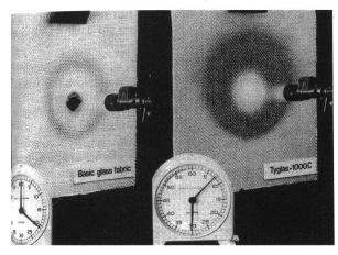
male Glasfaser (links) kann mit einem Bunsenbrenner in 20 Sekunazerstört werden; aber Tyglas 1000C (rechts) widersteht  $5\,\%$  Minulang Temperaturen bis zu  $800\,^{\circ}$  C.
