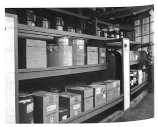
Multipack-Paternoster in einer Textilfärberei. In Dosen, Hobbocken, Kleincontainern und anderen Originalverpakkungen werden die mit Knopfdruck abgerufenen Farben zum Auswägen bequeme Arbeitsstellung gebracht.
