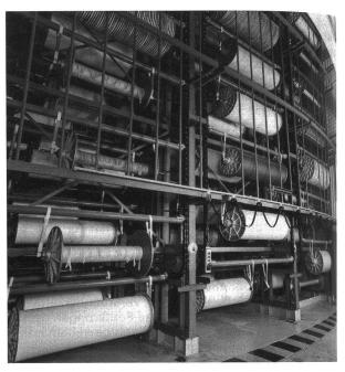
Gross-Paternoster in einer Weberei. In 3 parallelen Anlagen werden 354 Kettbäume gelagert und auf kürzestem Wege auf den Rollbock verladen. Die Inventaraufnahme wird bei diesen besonders unhandlichen Lagerobjekten ebenfalls gewälig erleichtert.
