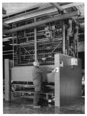
Kompakt-Paternoster für Druckwalzen. Die schweren und heiklen Walzen werden in dieser beidseitig bedienbaren Anlage risikofrei gelagert und auf die gewünschte Übernahmehöhe für den Transportkran gebracht.
