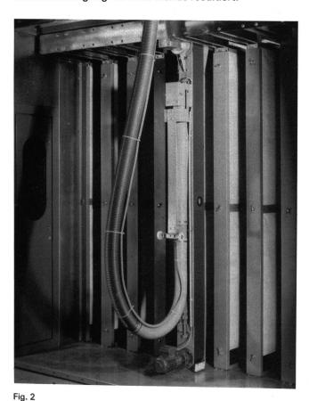
Die Filterzellen des Luwa<sup>®</sup> Automatik-Zellfilters Typ APF werden mit Hilfe eines Reinigungsroboters regeneriert.
