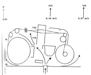
Raneiner Sulzer Projektilmaschine gemessenen relativen Luftfeuchmund Luftgeschwindigkeiten zeigen wie die Arbeitszone, aber auch Rkttfäden mit feuchter Luft versorgt werden. Die relative Feuchte imminit zunehmender Höhe über dem Boden stetig ab. Die höchste Wiebsgeschwindigkeit herrscht über den Schäften.
