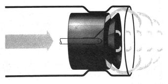
für eine russfreie Verbrennung. Bei Brennern ohne Verbrennungsoptimierung können keine konstanten CO²-Werte erreicht werden, da wie beschrieben in der reduzierten Leistung keine optimale Flammkopfeinstellung erreicht werden kann. Brenner mit VO-System zeichnen sich durch konstant hohe CO²-Messwerte aus. Sie liegen im Normalfall zwischen 12,5 und 13,5%, was zusammen mit einer niedrigen Abgastemperatur zu einem hohen Wirkungsgrad führt.
