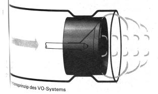
stufe angepasst werden kann. Es gilt vor allem durch bewegliche Elemente wie Luftregulierhülsen die Intensität der Mischung von Luft und Brennstoff zu beeinflussen.
