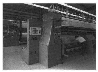
Teilansicht des modernen Stickereiwerks. Vier Hochleistungs-Stickmaschinen des Typs Saurer 1040 mit 15 Yards Sticklänge produzieren im Zweischichtbetrieb hochwertige Stickereien. Alle vier Maschinen verfügen über Saurer-Datamat-Steuerungen, die das Sticken ohne Punchkarte ermöglichen. Zwei Maschinen sind ausserdem mit der automatischen Stickstellenschaltung Saurer-Pentamat ausgerüstet.
