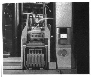
Schaltkasten für die Steuerung des Versatzes, des Nachzuges und der Maschenlängen
