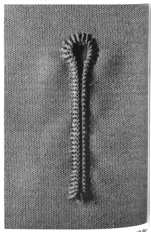
Das Knopfloch hat die Aufgabe, in Verbindung mit den Knopf als Verschluss zu dienen. Hierbei wird ein Einschnitt im Textilgut mit einer Naht versehen, um die Nähgut vor einem Ausfransen und Zerscheuem zuschützen.
