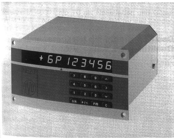
Bereits mit dem Standardprogramm bietet dieses Gerät 8 Vorwahlen und 1 Gesamtsummen-Zähler, die mit einer Zählgeschwindigkeit bis zu 10 kHz arbeiten. Daneben verfügt der Zähler über 4 Batch-Counter, die auch als Betriebsstundenzähler, Drehzahlmesser oder Anzeige der Liefergeschwindigkeit mit Grenzwert programmiert werden können. Das elektronische Getriebe überdeckt einen Bereich von 0,0001–99,9999. Eine Bedienerführung erleichtert die Programmierung.
