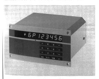
Bereits mit dem Standardprogramm bietet dieses Gerät 8 Vorwahlen und 1 Gesamtsummen-Zähler, die mit einer Zählgsschwindigkeit bis zu 10 kHz arbeiten. Daneben verfügt der Zähler über 4 Batch-Counter, die auch als Betriebsstundenzähler, Drehzahlmesser oder Anzeige der Liefergeschwindigkeit mit Grenzwert programmiert werden können. Das elektronische Getriebe überdeckt einen Bereich von 0,0001–99,9999. Eine Bedienerfühnung erleichtert die Programmierung.
