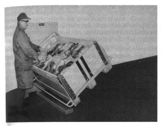
Palettenhub-Kippgeräte verhindern Rückenschmerzen durch Arbeiten ufder idealen Arbeitshöhe und reduzieren die Arbeitszeit.
