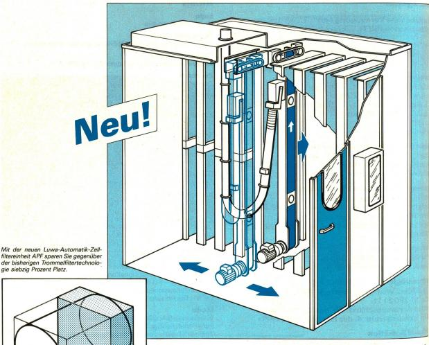
Mit dieser die Textillufttechnik revolutionierenden Luwa-Automatik-Zellfiltereinheit APF wird die bisherige Trommelfiltertechnologie verlassen und durch eine raumsparende sowie wirtschaftlich interessantere Neuentwicklung abgelöst. Bei verbessertem Filterwirkungsgrad wird eine bis heute unerreichte Wartungsfreundlichkei und Betriebssicherheit erzielt.
