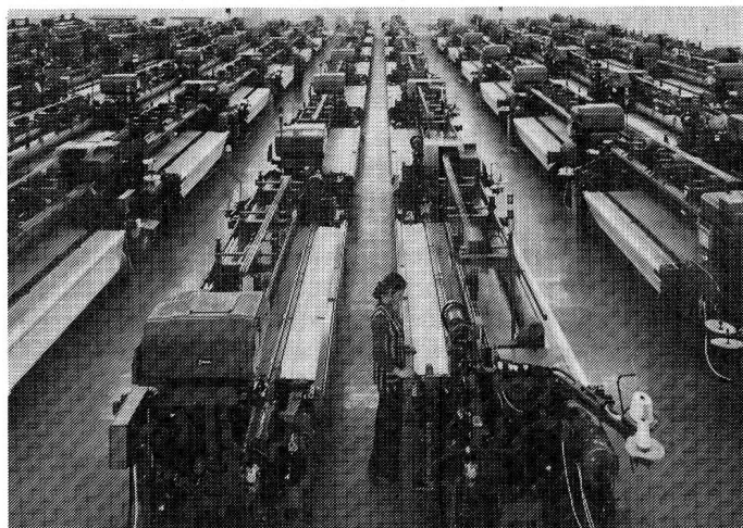
Der 1971 neu erstellte Websaal ist mit 98 Rüti C-Schützenmaschinen, alle mit Unifil und elektronischen Schützenflugmaschinen dotiert. Eine Weberin hat hier 24 der breiten Maschinen zu bedienen.
