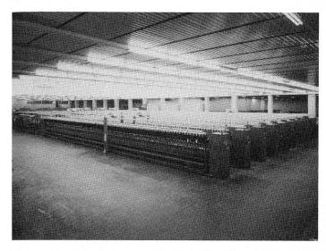
Gesamtansicht der 9 Ringspinnmaschinen G5/1DS und der angekoppelten Spulmaschinen. Die G5/1DS mit je 528 Spindeln ermöglichen einen optimalen und geordneten Materialfluss zwischen Ringspinnund Spulmaschinen.
