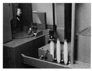
Der pneumatische Greifkopf fasst den Kops vom Dofferband und übergibt ihn der Spulmaschine.
