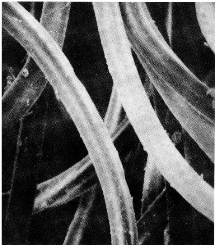
Teppichfasern mit Scotchgard-Teppichschutz weisen den Schmutz ab, ein Schutzfilm umhüllt jede einzelne Faser und die Reinigung wird wesentlich erleichtert.
