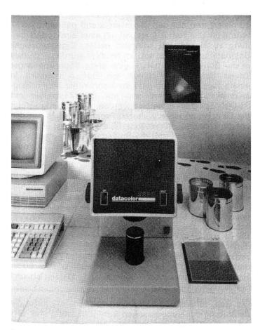
Farbmessgerät Datacolor Spektrofotometer 3890
