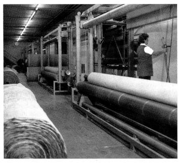
Das Weben ist eine jahrtausendealte Technik, die sich allerdings ständig verfeinert hat, und die Webmaschinen sind bis fünf Meter breit geworden. Der eigentliche Webvorgang ist indessen der gleiche geblieben: die in der Länge verlaufenden Kettfäden werden mit den quer eingetragenen Schussfäden verkreuzt oder verflechtet.
