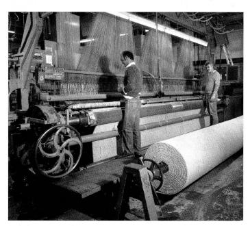
Das Tufting-Verfahren ist im Prinzip ein Sticken auf Riesennähmaschinen, die, je nach Breite und Dichte des gewünschten Teppichs, 600 bis 3500 Nadeln aufweisen. Das Polmaterial wird dabei auf der ganzen Breite in ein Trägergewebe eingenäht, das Halbfabrikat anschliessend gefärbt, geschoren und beschichtet.
