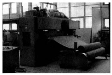
Bei der Fabrikation von Nadelfilz-Belägen werden keine einzelnen Polgarne verwendet, sondern man stellt aus Fasern (also nicht aus Garnen wie beim Web- oder Tufting-Verfahren) Faservliese her, welche durch Spezialnadeln in hoher Geschwindigkeit vernadelt, verdichtet und alsdann mit Spezialdispersion chemisch verfestigt werden.
