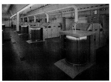
Flockenspeiseranlage Exactafeed® FBK 533 mit Hochleistungskarde Exactacard® DK 715
