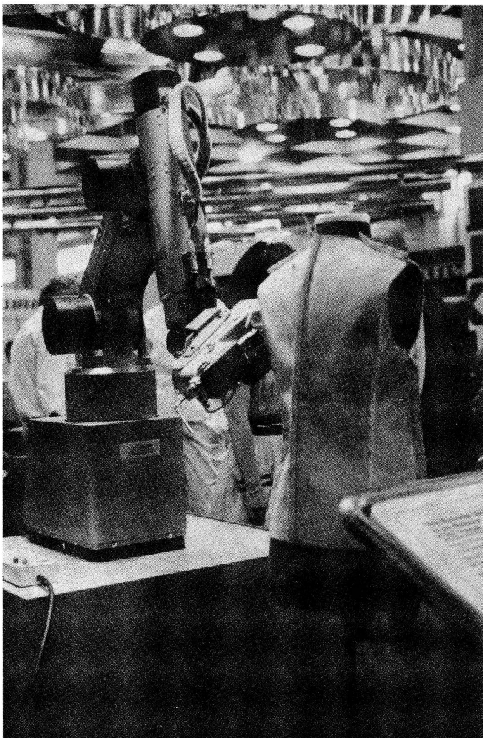
Bild 2 Japanisches Forschungsprojekt mit dreidimensional an einem Roboterarm bewegter Nähmaschine. Die Bekleidungsstücke sind auf einer 3-D-Puppe befestigt. (Bild: IUB Bäckmann)
