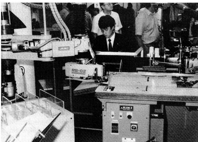
Bild 1 Roboter zum Absteppen von Hemdenkrägen: Die Teile werden vom Roboter vom Stapel abgenommen, der Maschine zugeführt und automatisch abgestapelt. Der Roboter ist so intelligent, dass er mangelhaft gefasste Teile selbständig wieder zurücklegt. (Bild: IUB Bäckmann)
