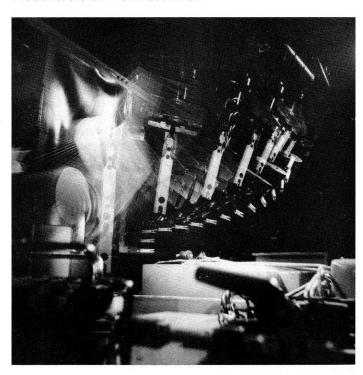
Zur wirtschaftlichen und präzisionsgerechten Herstellung seiner Webmaschinen, der Teile und Aggregate, setzt Sulzer Rüti flexible Fertigungssysteme mit Palettenspeicher, computergesteuerte Werkzeugmaschinen und Roboter ein. Das Bild zeigt die Bearbeitung eines Projektilkörpers mit Hilfe des Roboters im Sulzer-Rüti-Webmaschinenwerk in Zuchwil
