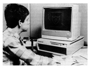
Das Easypunch-System gestattet das Entwerfen von Stickmustern auf einem Bildschirm, bevor diese automatisch auf die zur Steuerung der Stickmaschinen verwendeten Lochstreifen übertragen werden.
