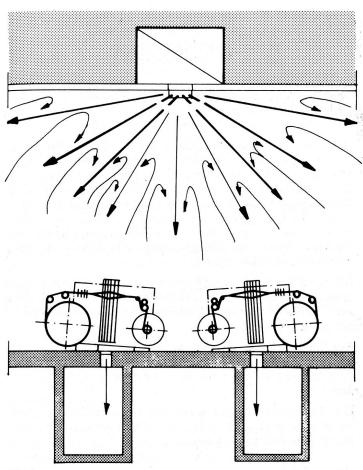
Bild 1 Konventionelles Klimasystem, Lufteinführung durch Lamellenauslässe.
