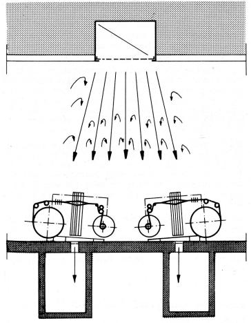
Bild 2 Konventionelles Klimasystem, Lufteinführung durch gelochte Platten.
