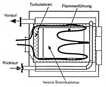
Die hydraulische Führung des Kesselwassers erlaubt den kondensatfreien Betrieb mit Niedertemperatur. Die gefürchtete Taupunktkorrosion kann daher nicht auftreten.
