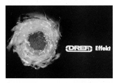
Für den Mantelanteil des herzustellenden Garns werden Abfallfasern grösserer Reinheit bzw. eines ansprechenden Farbtons verwendet. Das Endprodukt besteht aus einem Garn mit einwandfreiem optischen Aussehen, das dadurch den Anforderungen des Marktes voll entspricht. Dieser Vorteil kann gezielt im Hinblick auf das gewünschte Endprodukt eingesetzt werden.
