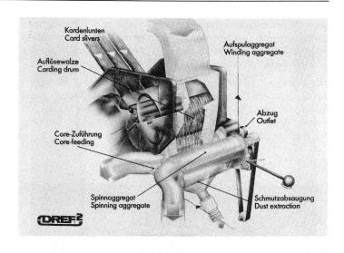
Die Fasern der Lunten können entweder unterschiedliche Faserprovenienz, unterschiedliche physikalische Eigenschaften oder, im einfachsten Fall, unterschiedliche Farbe aufweisen.
