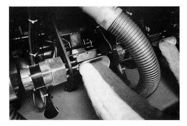
Der Garnkern wird durch die Rohmaterialien, die zur Bildung der Garnoberfläche verwendet werden, vollkommen abgedeckt, selbst wenn Rohmaterialien anderen Farbtons zur Bildung des Garnkerns herangezogen werden.
