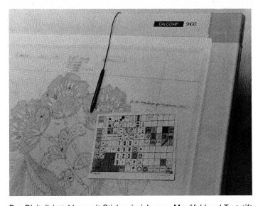
Das Digitalisiertableau mit Stickereizeichnung, Menüfeld und Taststift ersetzt die alte, mechanische Punchmaschine. Mit diesen neuen Hilfsmitteln und dem Computer-Programm (Software) werden in Zukunft die Steuerprogramme für Stickmaschinen erstellt.
