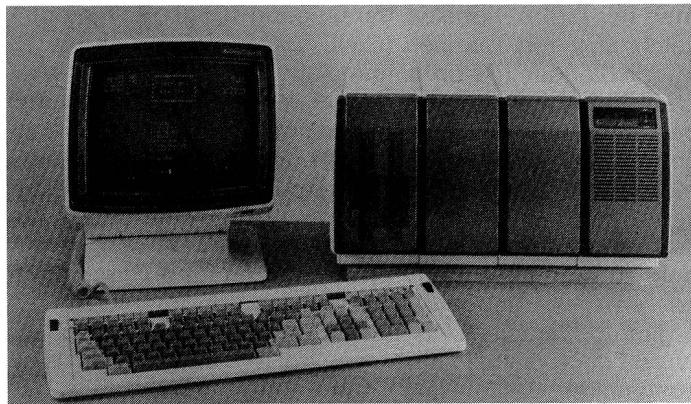
Ein Personal-Computer von Data General, zusammen mit Bildschirm und Bedien-Tastatur, verarbeitet die als Zeichnung eingegebenen Daten, steuert die automatische Zeichenmaschine (Plotter) sowie den Kartenstanzer und speichert die Steuerprogramme auf Disketten oder leitet sie über Kabel direkt in den Speicher der Stickmaschine.
