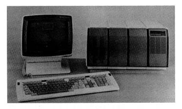
Ein Personal-Computer von Data General, zusammen mit Bildschirm und Bedien-Tastatur, verarbeitet die als Zeichnung eingegebenen Daten, steuert die automatische Zeichenmaschine (Plotter) sowie den Kartenstanzer und speichert die Steuerprogramme auf Disketten oder leitet sie über Kabel direkt in den Speicher der Stickmaschine.
