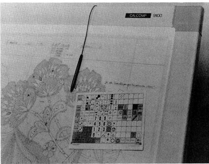
Das Digitalisiertableau mit Stickereizeichnung, Menüfeld und Taststift ersetzt die alte, mechanische Punchmaschine. Mit diesen neuen Hilfsmitteln und dem Computer-Programm (Software) werden in Zukunft die Steuerprogramme für Stickmaschinen erstellt.
