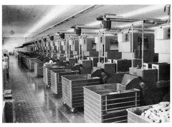
Bild 1 Einer der beiden Ringspinnsäle im Neubau mit Zinser-Ringspinnmaschinen und Doffer
