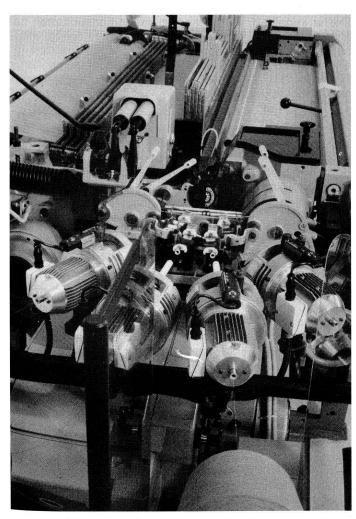
Bild Sulzer-Rüti-Schussspeicher PROFI 140 an einer Vierfarben-Projektilwebmaschine.
