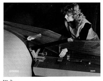
Abb. 7: Ausgeschwenkte Führungswalze mit automatischer Rückstellung des Schärblattes.
