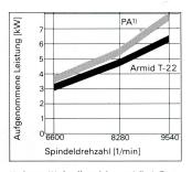
Modernste Werkstoffe und der spezielle Aufbau der neuen Armid-Tangentialriemen vermindern die Eigenenergieaufnahme des Riemens wesent lich. Gemäss Messungen eines Instituts für Textiltechnik konnte auf einer Ringspinnmaschine eine Reduktion der aufgenommenen Leistung, d.h. eine Senkung der Energiekosten um 14–18% beobachtet werden (möglicher Messfehler  $\pm\,4\,\%$ ).
