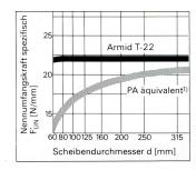
Im Vergleich zu Habasit Tangentialriemen mit Zugschichten aus Polyamid (PA) ermöglichen die neuen Armid-Tangentialriemen eine extrem hohe vom Scheibendurchmesser weitgehend unabhängige Leistungsübertragung pro mm Riemen
