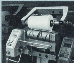
**FMP** mit elektronisch gesteuerter Präzisionswicklung für Fachspulen mit extrem hoher Dichte.
