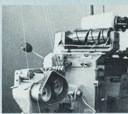
**SM** die universelle Strangspulmaschine mit Einzelantrieb und elektronisch gesteuertem Langsamlauf, erhältlich mit Rillentrommeln oder Fadenführern.
