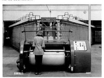
Bild 7 Hochleistungszettelanlage ZDA/GE/GCF
