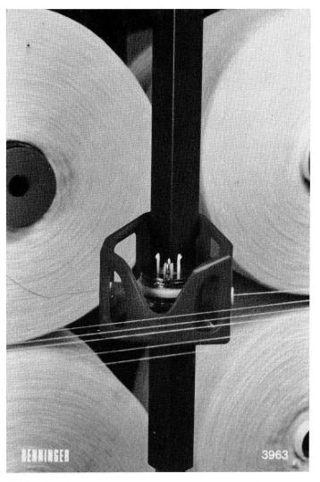
Bild 5 Fadenspanner, Modell UZ, für konventionelle Zettelanlagen
