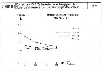
Bild 8 Kosten pro 1000 Zettelmeter in Abhängigkeit des Spulendurchmessers bei Hochleistungszettelanlagen
