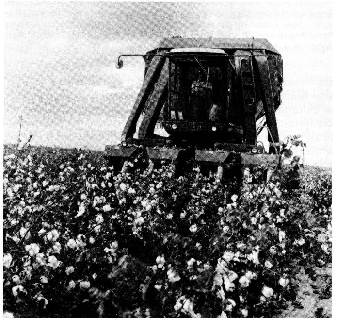
Beim maschinellen Ernten stellt sich das Problem, die feinen Samenhaare nicht zu beschädigen und möglichst nur die Baumwollkapseln ohne Stiele und Blattwerk einzusammeln. Obwohl heute der Hauptteil der Baumwolle auf diese Art eingebracht wird, sucht man nach rationellen aber noch schonenderen Methoden.
