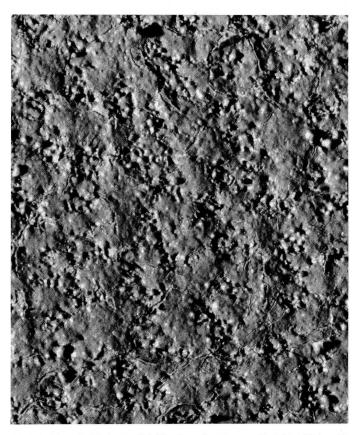
Abb. 1: Vom Reiniger zu dickflüssig aufgetragene Zurichtschicht, die zudem spröde ist.
