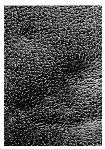
Abb. 6: Punktweises Schrumpfen von Leder, vermutlich durch Aufspritzen von heissem ÖI.
