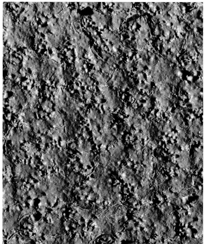
Abb. 1: Vom Reiniger zu dickflüssig aufgetragene Zurichtschicht, die zudem spröde ist.
