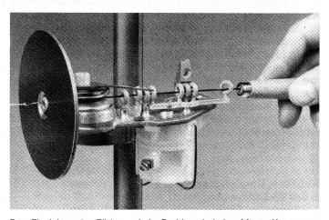
Das Einziehen der Fäden – kein Problem bei den Mayer-Kompensations-Fadenspannungsreglern, da alle Ösen in einer Flucht liegen
