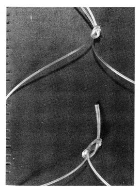
Bild 3 zeigt beschädigte Fibrillen am Einfachknoten eines Glasfasergarnes.
