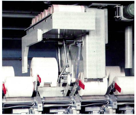
Ein bewährtes System: Starter-Spulmaschine und Kreuzspulenwechsler.
