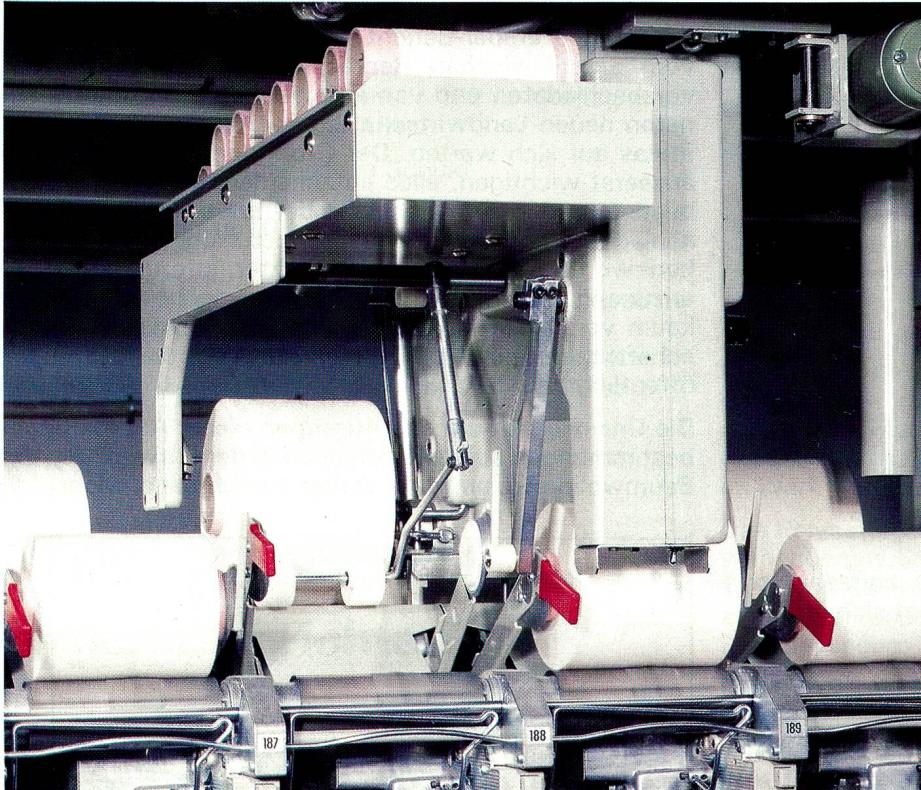
Ein bewährtes System: Starter-Spulenmaschine und Kreuzspulenwechsler.
